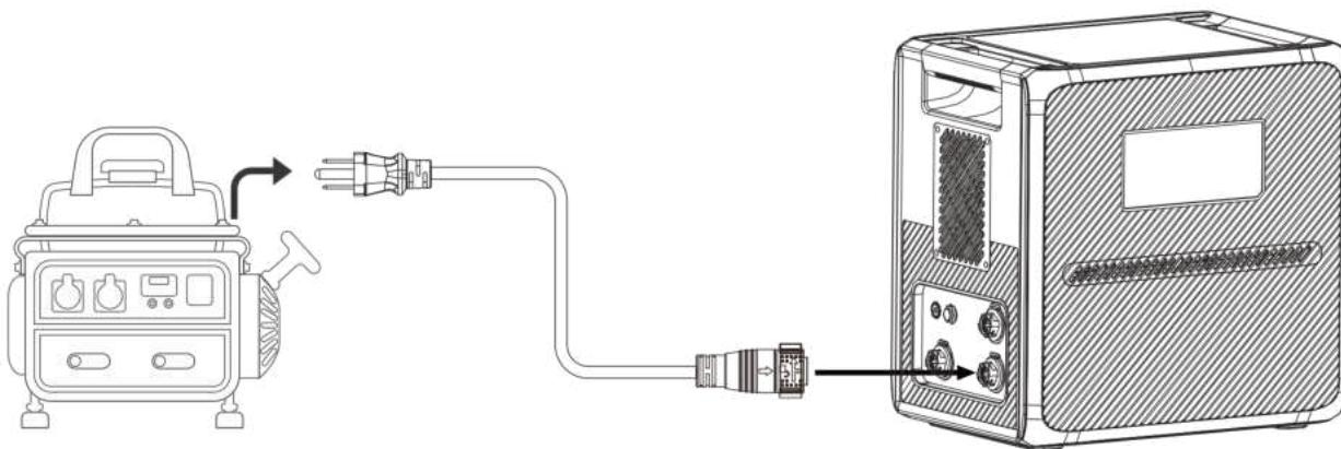
**Примітка:** Переконайтесь, що ваш генератор видає змінний струм із зарядною напругою, частотою та напругою в режимі самонастроювання мережі, які відповідають специфікаціям AC240.
